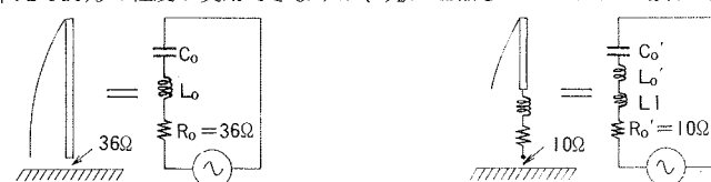
Fig 9 アンテナの等価回路
